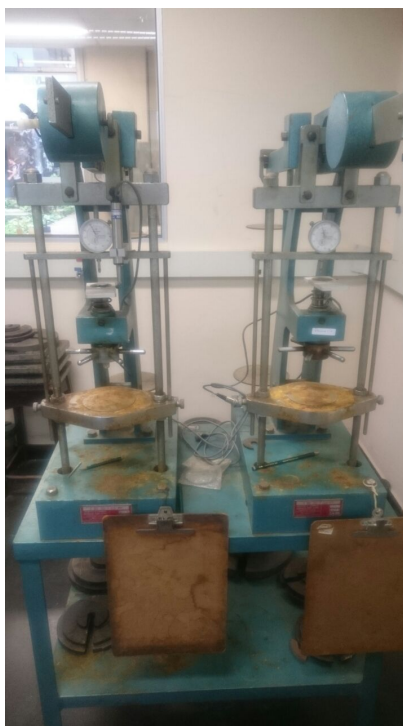
Figura 10 - Prensas de adensamento utilizadas (Laboratório de Mecânica dos Solos da Engenharia Civil - Poli - USP)
