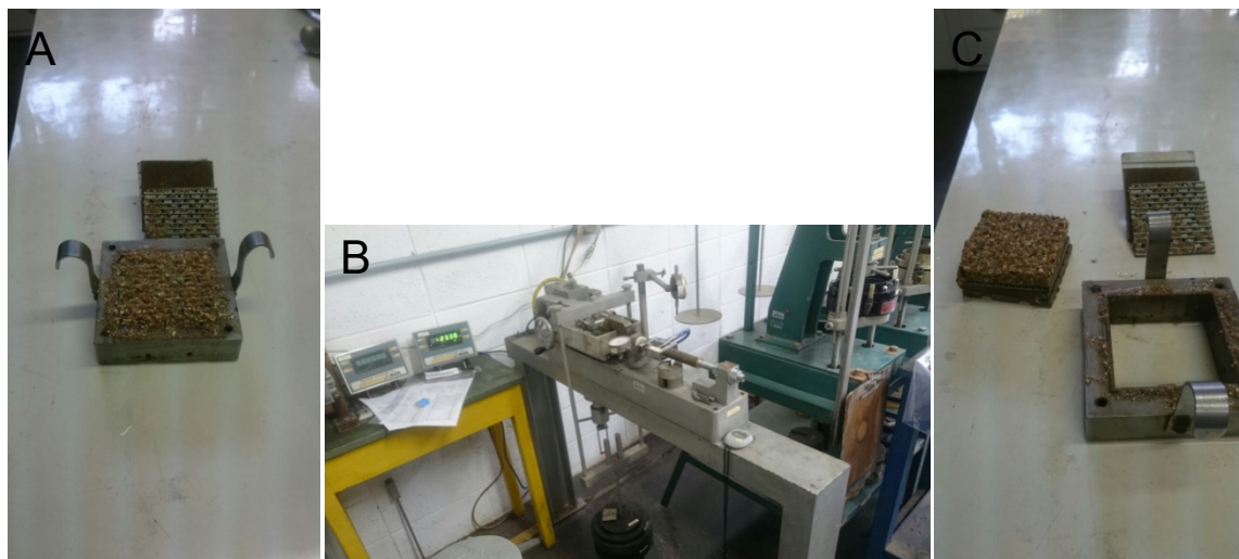
Figura 11 - Da esquerda para a direita: (A) material na caixa de cisalhamento, (B) máquina de cisalhamento e (C) material retirado da máquina de cisalhamento. Ensaio realizado no Instituto de Pesquisas Tecnológicas – USP.
